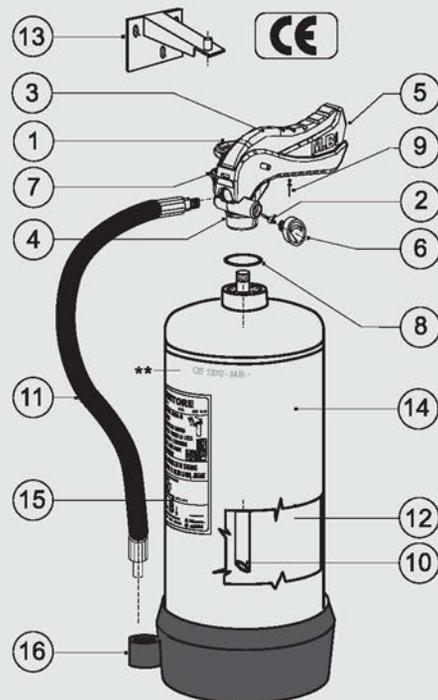
\*\* Marchiatura serbatoio: (Ente di Sorveglianza) **CE 1370**, produttore serbatoio, decimale anno produzione, (Codice identificativo produttore) **0095**, n° matricola serbatoio, (Pressione di collaudo) PT xx Bar.
